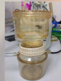
过滤装置应用于水测试。
